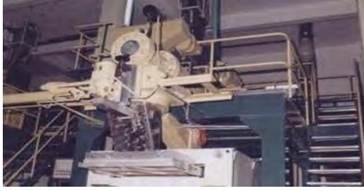
مكبس ( PRES) يقوم بخلط دقيق السميد الوارد من مصنع الطاحون بالماء ونقله عن طريق الحلزونات إلى القوالب الموجودة في الرأس حيث يتم ضغط العجين إلى القوالب ليتم تشكيل المكرونة. جميع أقسام المكبس التي لها صلة مباشرة بالمنتج يتم صناعتها من الصلب ضد الصدا. والرأس وباقي الأقسام تكون من ( sifero)المصبوب. وسيكون عيار الماء ودقيق السميد في المكبس ألياً.
